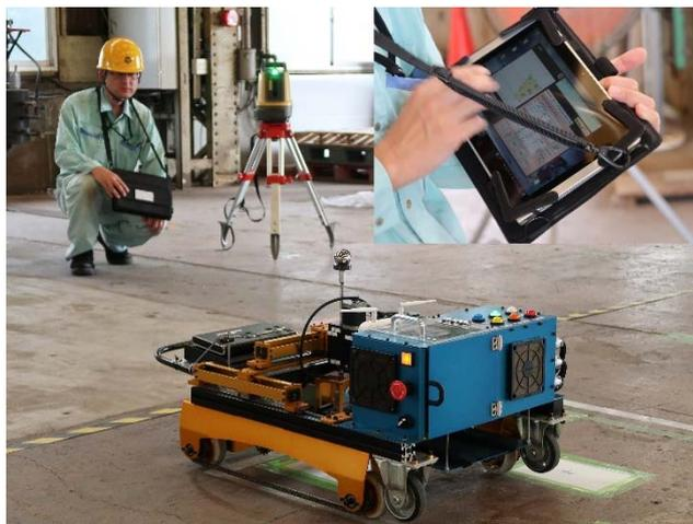
自動墨出しロボットシステムによる作業（右上は作業指示用タブレット端末）
